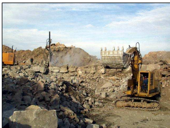
Foto 18: Línea de barrenos para voladura
